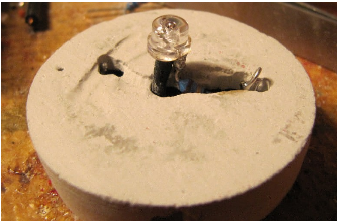
Abbildung 6: Alles eingebaut - LED, Widerstand, Schalter und Knopfzellenhalterung
